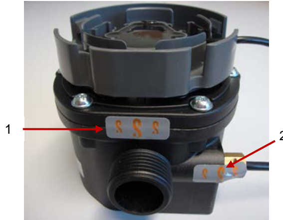
Im Werk angebrachte Plombierungen am Durchflusssensor (1) und am Temperaturfühler (2) des Superstatic 789
