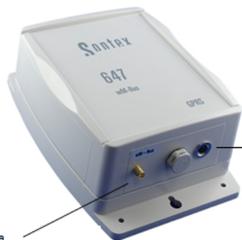
USB/power supply connector Connecteur USB / Alimentation USB/Stromversorgungsbuchse Connettore USB / Alimentazione
