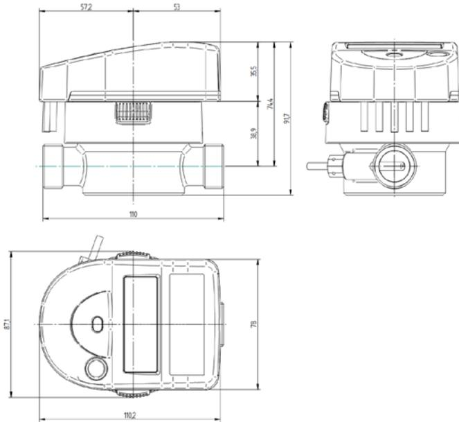
**Mehrstrahl-Messkapsel Durchflusssensor für G2" Anschlussstück**
