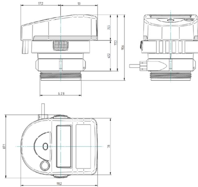
**Mehrstrahl-Messkapsel Durchflusssensor für M77x1,5 Anschlussstück**
