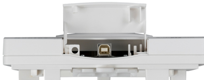
Vue devant avec couvercle ouvert et interface USB
