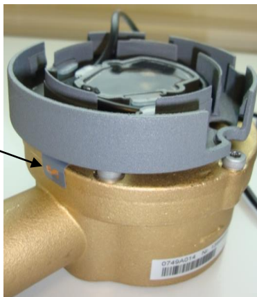
Sigilli di fabbrica sulla volumetrica (1) e la sonda di temperatura (2) del Superstatic 749
