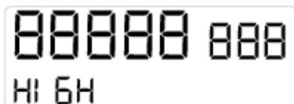
Aux fins de la vérification métrologique du compteur par un laboratoire agréé, l'affichage de la consommation sur l'appareil peut être remplacé par un affichage à haute résolution pour une durée maximale de 24 heures. Au lieu du m<sup>3</sup> habituel, l'écran passera en millilitres. Ce mode est indiqué sur l'écran de l'appareil par le mot stylisé "HIGH". Au plus tard à la transition de minuit, l'affichage est automatiquement ramené à l'affichage standard des m<sup>3</sup>.
