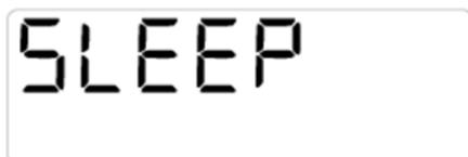
La modalità SLEEP è il normale stato di consegna del contatore. In questa modalità il contatore è già in stato di conteggiare il consumo, ma la trasmissione radio non è ancora attivata per risparmiare energia nel corso del trasporto fino all'installazione.
