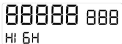
Ai fini della verifica metrologica del contatore da parte di un laboratorio autorizzato, il display del consumo sul dispositivo può essere sostituito da un display ad alta risoluzione per un massimo di 24 ore. Invece dei soliti m<sup>3</sup>, il display passa a millilitri. Questa modalità è indicata sul display dalla parola stilizzata "HIGH". Al più tardi al passaggio della mezzanotte, il display torna automaticamente alla visualizzazione standard m<sup>3</sup>.
