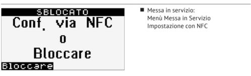
La sigillatura può essere fatta tramite NFC con l'app Superprog Android o tramite la testina ottica o M-Bus con l'app Superprog Windows.
